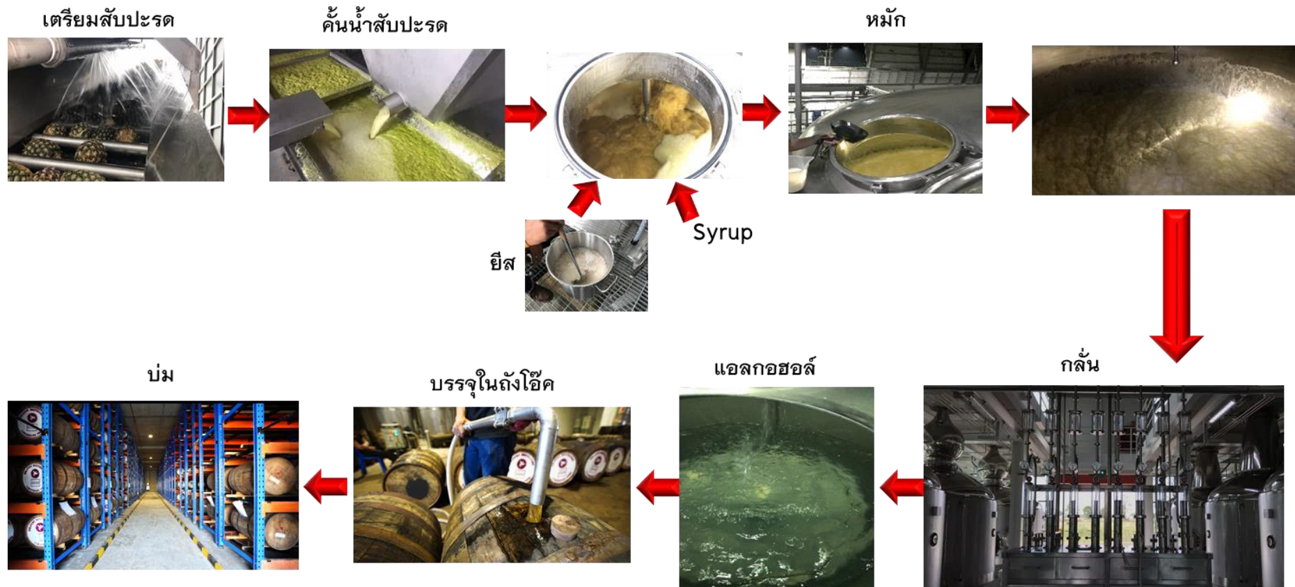
รูปที่ 2.4.3-1 กระบวนการผลิตสุรากลั่นชนิดสุราพิเศษประเภทบรันดี โดยใช้ผลไม้เป็นวัตถุดิบ
